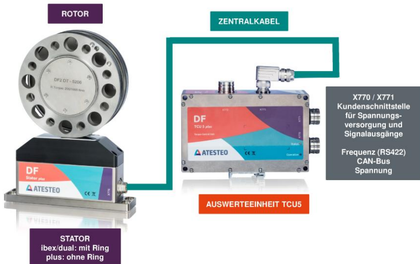
Abbildung 1 DF-Systemübersicht (Komponenten am Beispiel DF2 plus)
